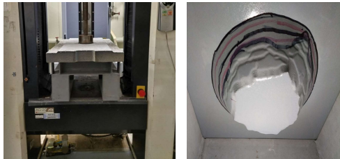
押抜き試験状況
