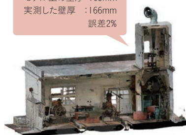
三次元モデルを活用した部材厚測定の実例 (野島崎灯台霧信号舎、1924年竣工)
