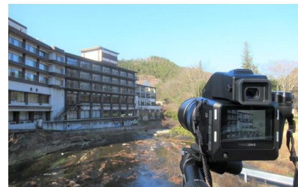
コンスファインダー4G (高画素・高精細カメラを使用した目視調査手法)
