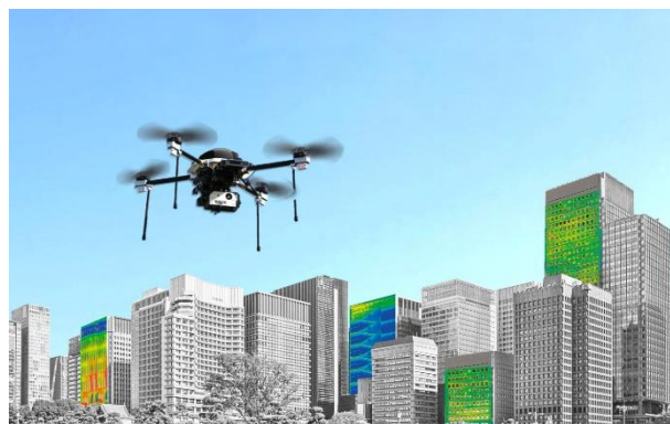
コンスファインダーSKY (赤外線×ドローンによる外壁調査)
